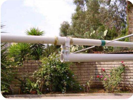
Per evitare la flessione orizzontale dell'antenna, la foto mostra una serie di fori praticati sul primo e sul terzo troncone di mast, il cui diametro è stato portato a 25 mm., incollandovi sopra del tubo da 25.
