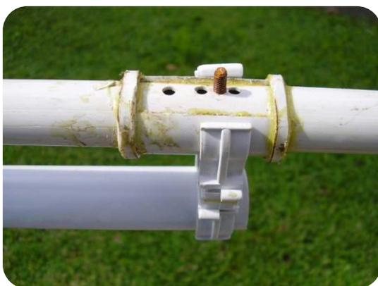
Il metodo di costruzione del dipolo è affidato al buon senso del realizzatore. Gaetano HJN che ha ribattuto il tondino di alluminio da 5 mm appiattendolo, lo ha poi forato e ha fissato a loro volta i due semidipoli con delle viti su plastica, irrigidendo poi tutto con delle legature, successivamente ricoperte di collante.
