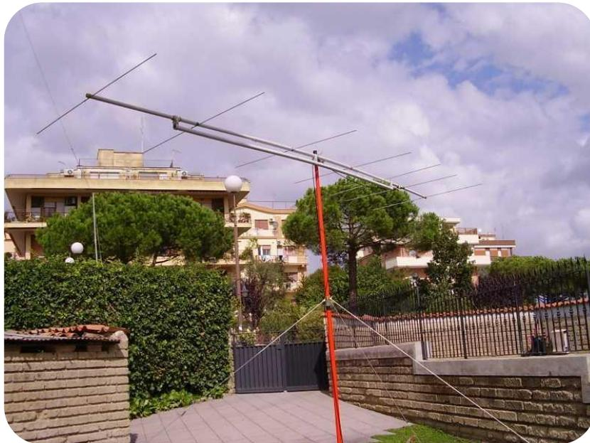
La 7HJN che Gaetano ha realizzato offre, oltre a tutto, un lobo più che buono ed un guadagno di 11 dBd, ovvero 0,6 dB sulla 9 Tonnà, ottenuto grazie ad una migliore ottimizzazione, senza parlare dell'assenza di un qualsiasi sistema di adattamento di impedenza, perché non necessario.
