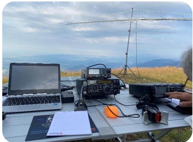
Sistemati due tavolini a ridosso del camper e il materiale, prendendo l'alimentazione dal camper e sistemando l'antenna yagi e una Endfed per le hf alle 7.30 eravamo praticamente
