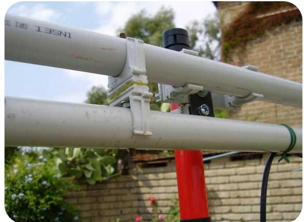
Gli elementi passivi sono realizzati in tondino di alluminio da 5 mm, passanti attraverso il boom. Per renderne il fissaggio, per così dire, "pastoso", sono stati infilati all'interno dei tre semi-boom, in corrispondenza della posizione dei direttori e del riflettore dei pezzetti di tubo flessibile da giardinaggio di diametro adatto in modo che essi non possano poi scorrere.
